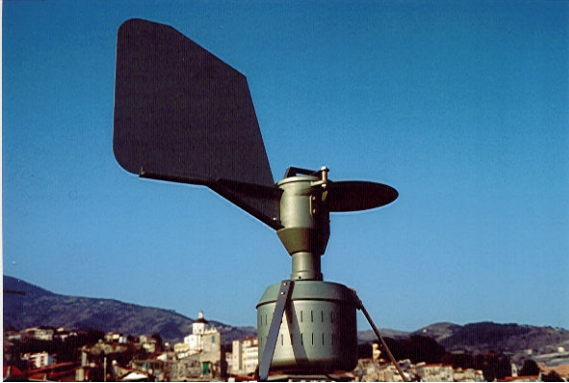
FIGURA 4 - Spore trap volumetrico modello Burkard situato a Sanremo
