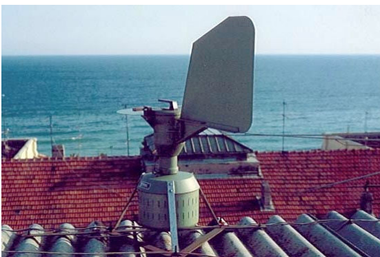
Figura 8 - Campionatore per impatto di depressione. Apparecchio di Hirst, modello Burkard.
